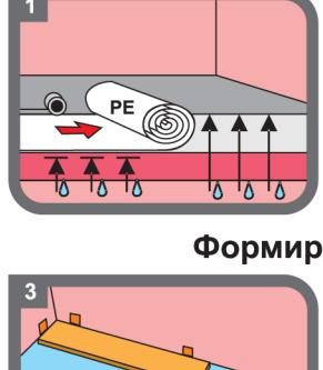
Неровности основания для укладки ламинированных полов, превышающие 2 мм на 1 м длины укладки, должны быть устранены.
