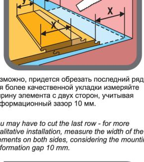
Необходимо соблюдать монтажные деформационные зазоры: не менее 10 мм от края покрытия до стен.
