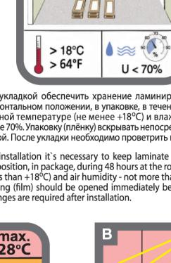
Перед укладкой обеспечить хранение ламинированных полов в горизонтальном положении, в упаковке, в течение 48 часов при комнатной температуре (не менее +18°C) и влажности воздуха не более 70%. Упаковку (плёнку) вскрывать непосредственно перед укладкой. После укладки необходимо проветрить помещение.
