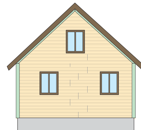
Рис. 33. Смещение «нахлестов» на сайдинговой обшивке
